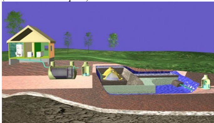
Prinsippskisse av våtmarksfilter med forfilter. (Kilde: www.avlop.no)
